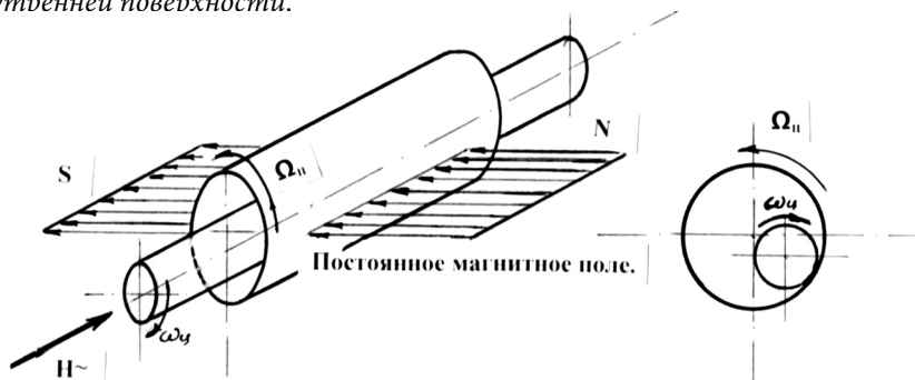
Рис. 48. Схема эксперимента вращения ферритового цилиндра в скрещенных полях [57].
