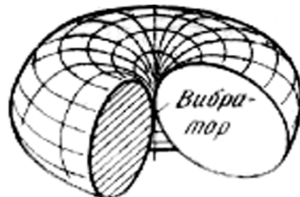
Рис. 9. Трёхмерный вид ТОРОИДАЛЬНОЙ диаграммы направленности вертикально стоящего симметричного диполя. Часто такие диаграммы называют ненаправленными, то есть способными принимать и излучать сигналы в любом направлении. [30].
