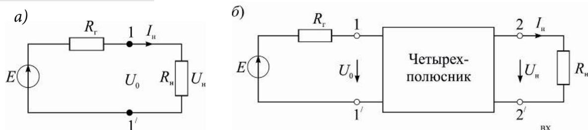
Рисунок 10 – Простейшие электрические цепи:
