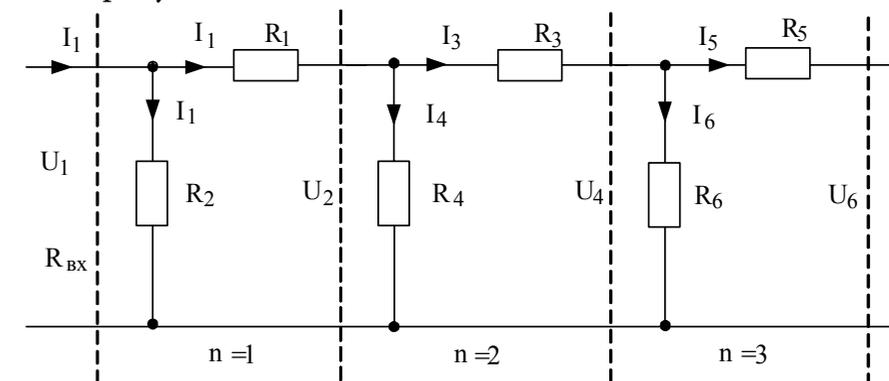
Рисунок 7 – Однородная Г-образная электрическая цепь
