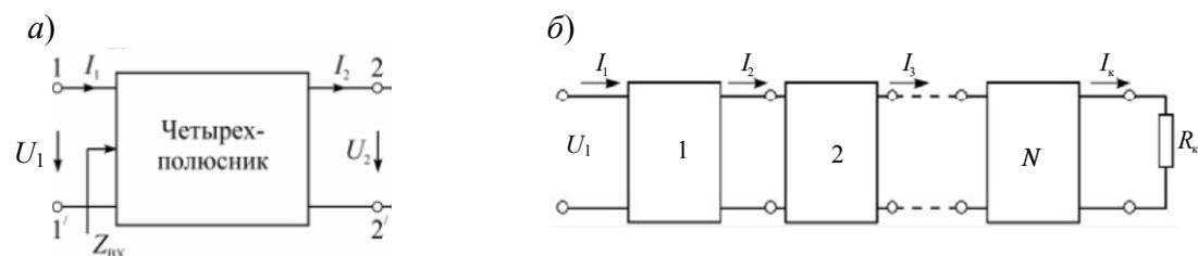
Рисунок 3 – Электрическая цепь как четырехполюсник
