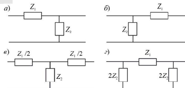
Рисунок 4 – Структуры четырехполюсников: а – несимметричная Т-образная с входом типа Т; б – несимметричная Г-образная с входом типа П; в – симметричная Т-образная; г – симметричная П-образная
