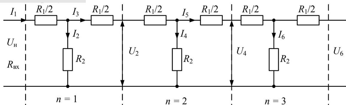
Рисунок 8 – Однородная Т-образная электрическая цепь
