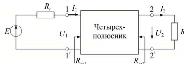
Рисунок 5 – Электрическая цепь при передаче энергии через четырехполюсник
