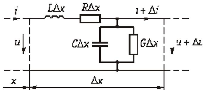
Рисунок 2 – Элемент электрической цепи с распределенными параметрами
