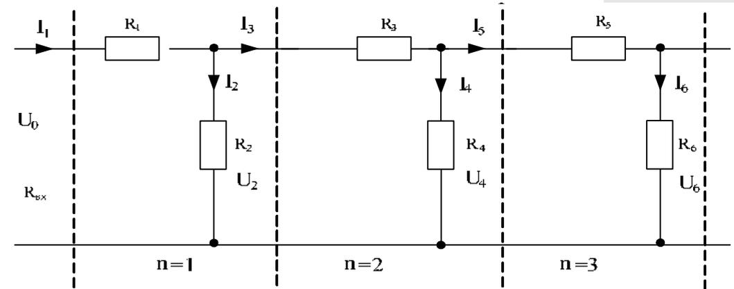
Рисунок 6 – Однородная Т-образная электрическая цепь
