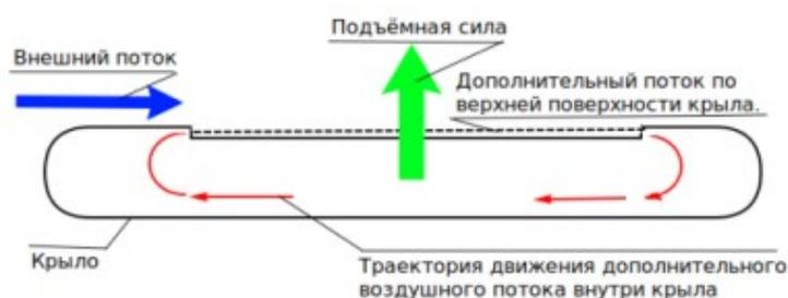
Можно данный способ создания подъёмной силы использовать в аппарате, похожем на летающую тарелку. Для этого надо создать на верхней поверхности на все 360 градусов радиальный поток воздуха (воды) от верха тарелки до её периферии. Этот способ создания подъёмной силы как для крыла, так и для «тарелки» запатентован двумя прибалтийскими изобретателями. И, похоже, такой способ имеет большое будущее.
