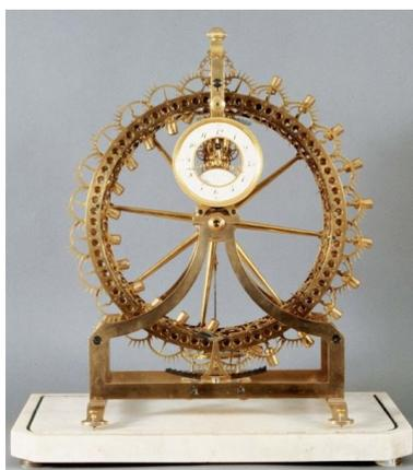
Секрет их работы тот же, что и у колеса Альдо Коста. В нижней точке колёсико с грузом проворачивается и дебаланс (груз) смещается к центру колеса. А в верхней точке опять колёсико с грузом поворачивается и груз смещается подальше от оси. В результате часовое колесо всегда остаётся неуравновешенным и поэтому постоянно подкручивает пружину часового механизма.
