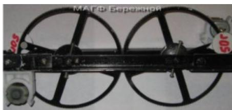
У этого центробежного движителя первый левый диск вращается от моторчика, а второй вращается первым посредством зубчатой передачи. Дебаланс на каждом диске имеет массу 50 г. Когда плоскость вращения дисков с дебалансом не изменяется в пространстве, то это устройство ничем не отличается от вибратора.
