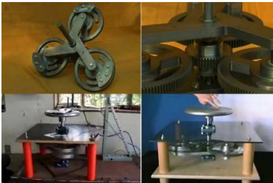
Рис.9. Три колеса в колесе в сборе и в работе.
