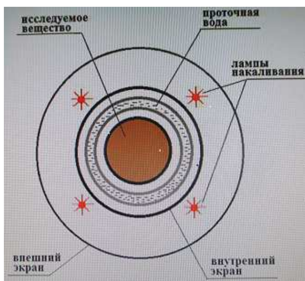
Рис. 5. Принципиальная схема реактора с лампами накаливания. [12].
