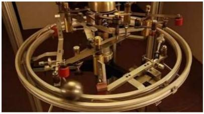
Сразу видно, что кольцевые рельсы, по которым вращается большой шар, различные. На левом рисунке (фото) рельсы сделаны из цельного "куска" металла, а для рычагов, на которые в процессе вращения "наезжает" большой шар, сделаны прорези. На правом рисунке (фото) наружная и внутренняя рельса изготовлены отдельными друг от друга, а в конструкции они соединены тремя стяжками. Также, мне кажется, что система рычагов на левой конструкции проще, чем на правой. Хотя в этом я могу и ошибаться.
