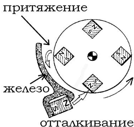
Рис. 165. Магнитный мотор с экранированием части цикла.
