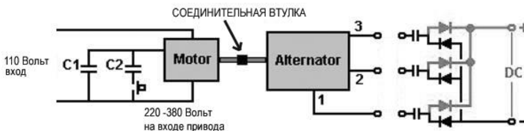
Рис.109. Схема мотор-генератора. Подробнее на сайте www.free-energy-info.com
