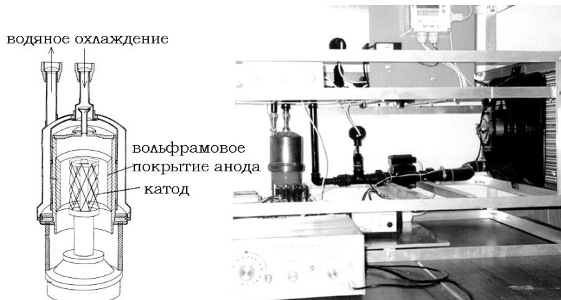
Рис. 234. Схема реактора и фото испытательного стенда, 2003 год, ООО «Лаборатория Новых Технологий Фарадей»
