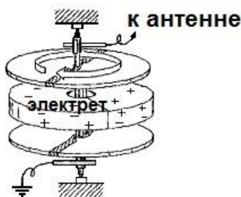
Рис. 77. Электростатический мотор Ефименко с электретным ротором.
