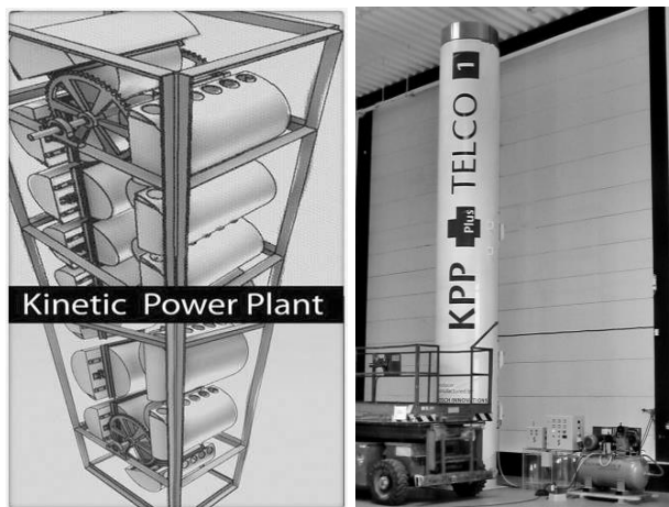
Рис. 22. Схема устройств Маркелова В.Ф. и генератора Rosch KPP
