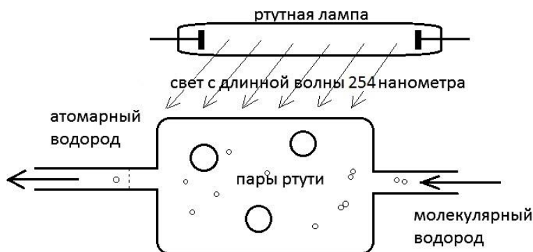
Рис. 235. Схема Бонгефера по получению атомарного водорода.
