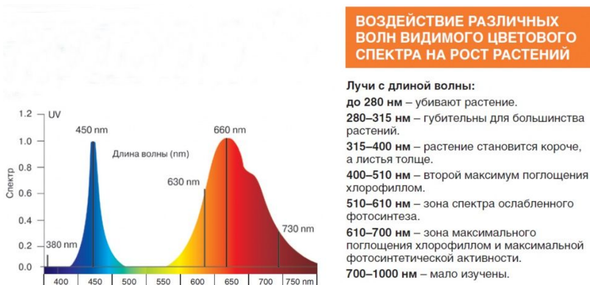
Рис.4. Воздействие различных волн видимого цветового спектра на рост растений
