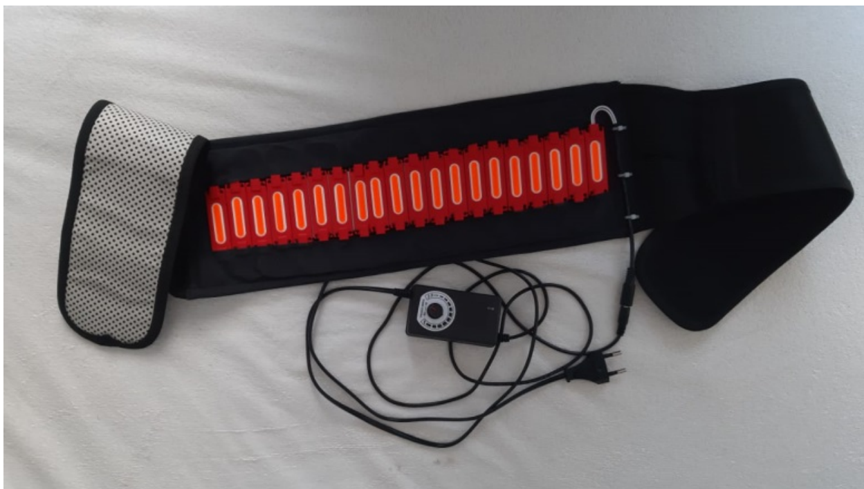
Рис. 37. Опытный образец красного пояса, созданный на основе проведенных исследований. Его характеристики: напряжение АС — 220 В, ток матрицы — 1,5 А, мощность — не более 20 Вт. Габариты: 1200x150. Вес — не более 0,5 кг
