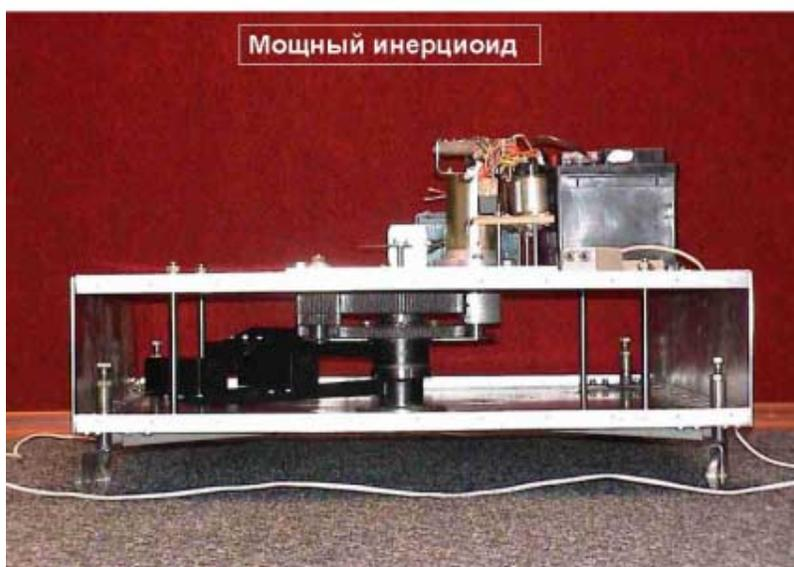
Рис. 10: Мощный инерцоид с тягой в импульсе 11 кг.
