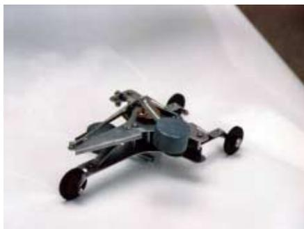
Рис. 1: Однотактный инерцоид Толчина с пружинным заводом
