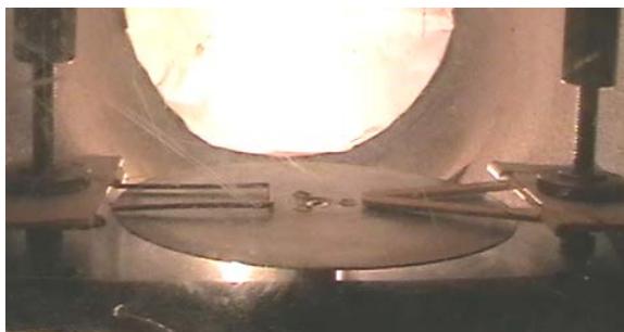
Рис. 12. Рамки 2 из латуни и дерева отклоняются при вращении диска на углы 10^\circ \sim 20^\circ оттапливает две рамки 2, расположенные справа и слева от центра диска. Рамка слева изготовлена из латунной проволоки, а рамка справа из дерева. Рамки установлены на шарнирах и могут поворачиваться вверх. Когда угловая скорость вращения диска достигает величины \omega \sim 150 об/сек, рамки, вибрируя, отклоняются вверх, образуя угол 10^\circ \sim 20^\circ между плоскостями рамок и плоскостью диска. Конечно, эти эксперименты необходимо довести до академического уровня, но теория предсказывает и предварительные экспери-
