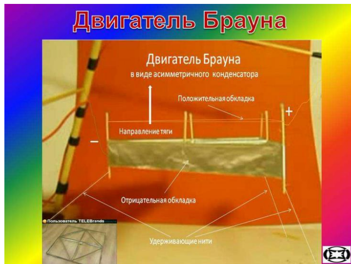
Рис.3. Двигатель Брауна, предлагаемый для безопорного движения.
