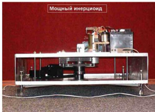
Рис. 10. Мощный инерцоид с тягой в импульсе 11 кг.
