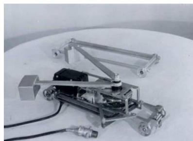
Рис. 9. Мощный инерцоид Толчина с максимальной тягой в импульсе 15 кг.
