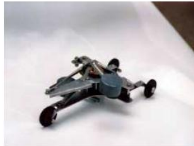
Рис. 7: Однотактный инерцоид Толчина с пружинным заводом
