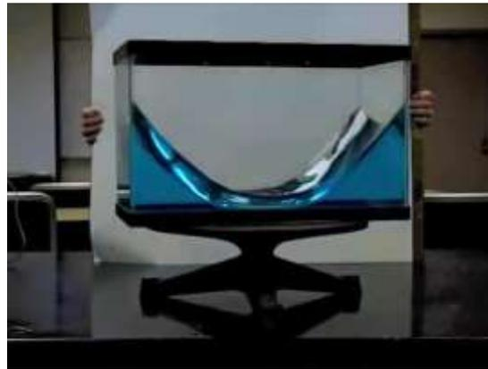
Рис. 1. Искривление поверхности воды при вращении сосуда
