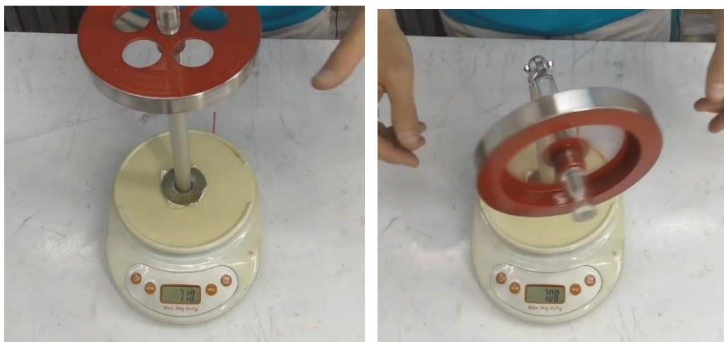
Рис. 5. Слева весы показывают вес не вращающегося гироскопа 710 грамм; справа прецессирующий гироскоп весит 708 грамм.
