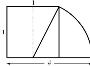
Построение отрезка длиной  $\phi$  с помощью квадрата единичной длины
