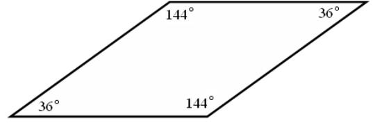
Углы в ромбе с отношением длин диагоналей равно  $\phi$  определяются из равенств  $2\arctg \phi^{-1} = \arctg 2$  и  $2\arctg \phi = \pi - \arctg 2$
