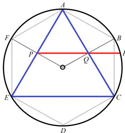
В этом примере золотой отрезок строится посредством трёх разных геометрических фигур. Соединяя через одну вершины вписанного в окружность правильного шестиугольника  $ABCDEF$ , придём к равностороннему треугольнику  $ACE$ . Проведённые из центра окружности к вершинам шестиугольника  $F$  и  $B$  прямые пересекают треугольник в  $P$  и  $Q$ . Соединяющая эти две точки прямая пересекает окружность в точке  $R$ , образуя отрезок  $PR$ , для которого  $PR : PQ = PQ : QR = \phi$ .
