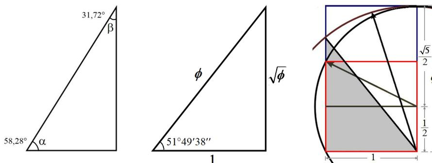
Треугольник, для которого  $\text{tg } \alpha = \phi$  (слева); треугольник Кеплера и его построение
