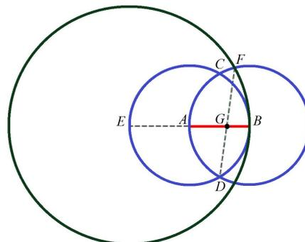
Две равные окружности радиусом  $AB$  с центрами в точках  $A$  и  $B$  пересекаются в точках  $C$  и  $D$ . Далее с центром в точке  $E$  радиусом  $EB = 2AB$  проводим окружность, пересекающую одну из малых окружностей в точке  $F$ . Отрезок  $FD$  пересекает  $AB$  в золотой точке  $G$ , так что  $AB : AG = AG : GB = \phi$  (доказательство в [Hofstetter], см. также [Bogomolny<sup>1</sup>]).
