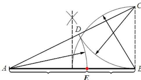
Построение золотой точки  $E$  на отрезке  $AB$ .  $AB:AE = AE:EB = \phi$
