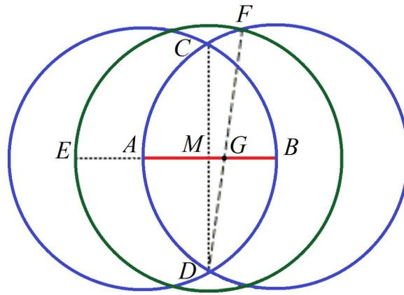
Как и в предыдущем примере, две равные окружности пересекаются в точках  $C$  и  $D$ . Отрезок  $CD$  делит  $AB$  пополам точкой  $M$ . Окружность радиусом  $AB$  и с центром в  $M$  приводит к отрезку  $FD$ , пересекающему  $AB$  в золотой точке  $G$ . Таким образом, и здесь  $AB : AG = AG : GB = \phi$  [Там же].
