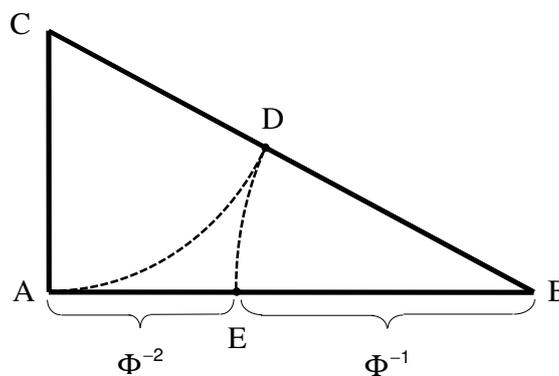
Рис. 3. Геометрическое построение золотого сечения
